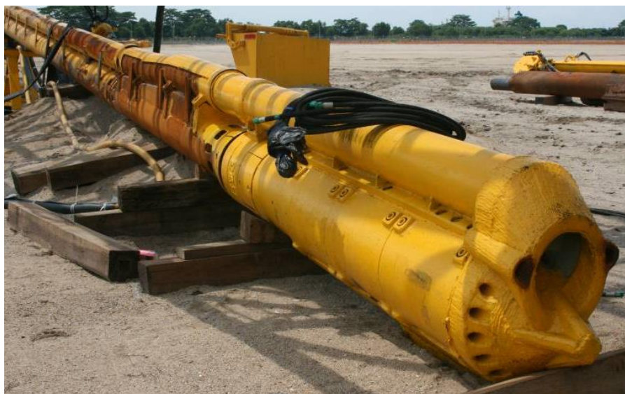
Figura 5: Tipica attrezzatura per colonne di ghiaia con immissione della ghiaia a secco a fondo foro – Dettaglio della punta dell’utensile (nota ugelli per l’iniezione di acqua o aria) e tubo di consegna ghiaia
