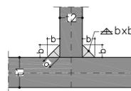
i cordoni d'angolo che uniscono due laminati di spessore  $t_1$  e  $t_2$  con  $t_2 \leq t_1$ , devono avere il lato "b" soddisfacente le condizioni di calcolo e, di regola, le seguenti limitazioni:
