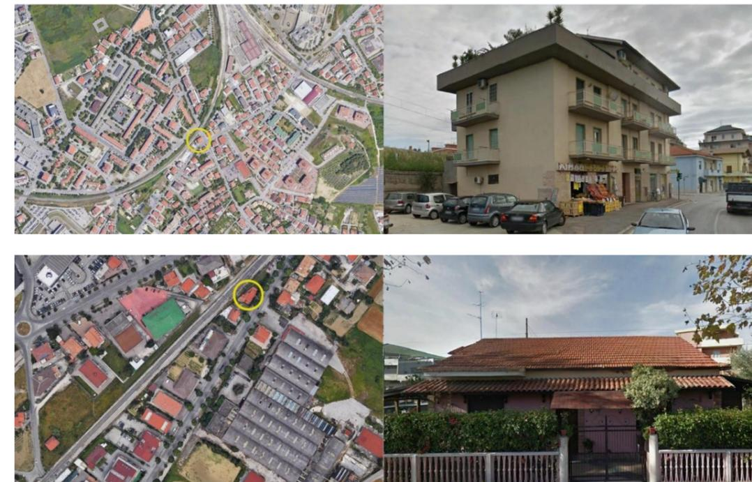
Figura 4-9 Manufatti di tipo residenziale. La palazzina sopra interferisce con le opere di linea RI01 e RI01D alla Pk 0+140,471, il manufatto sotto interferisce con l'opera di linea RI07 e RI07B alla Pk 4+993,869.
