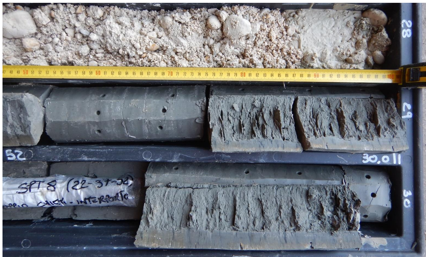
Figura 5-11. Argille-marnose grigie azzurre, cassetta del sondaggio S4.
