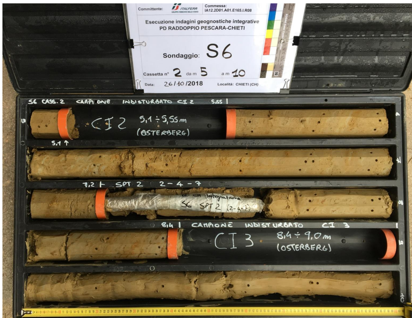
Figura 5-9. Foto del sondaggio S6 (tra 5 e 10m) in cui le alluvioni si presentano limoso-sabbiose ocra marrone chiaro.
