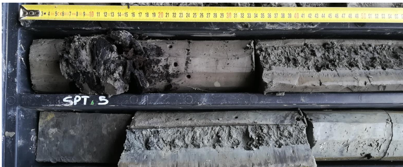
Figura 5-10. Foto del particolare del sondaggio S7 in cui si intercettano livelli di materia organica (torba) all'interno dei limi-argillosi grigi.
