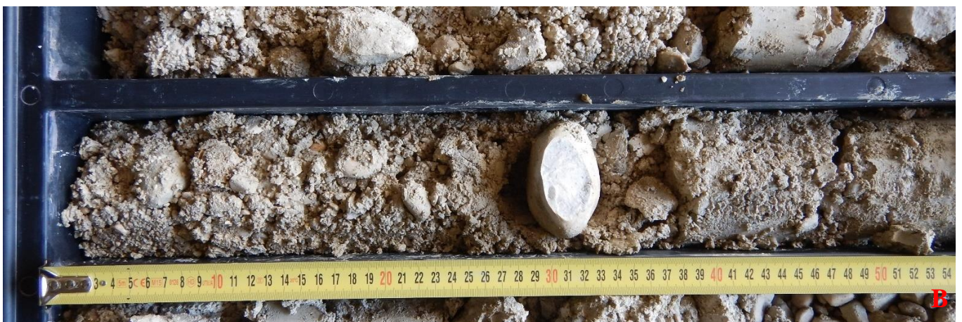
Figura 5-8. Foto del sondaggio S2 cassetta 3, in cui si possono distinguere uno strati ghiaioso-sabbiosi di colore avana con intercalazione di materiale di limo-sabbioso e sabbioso (A). Foto rappresentativa del sondaggio S2, in cui si possono distinguere uno strati ghiaioso-sabbiosi di colore avana con clasti di natura carbonatica sub arrotondati (B).
