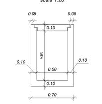
Dettaglio "3" - Canalizzazioni per alimentazione elettrica linea
