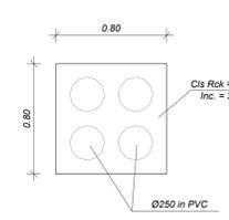
Dettaglio "4" - Canaletta idraulica al piede dell'opera di sostegno
