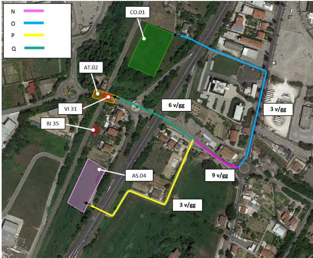
Figura 6-6 Flussi di traffico terzo scenario di simulazione
