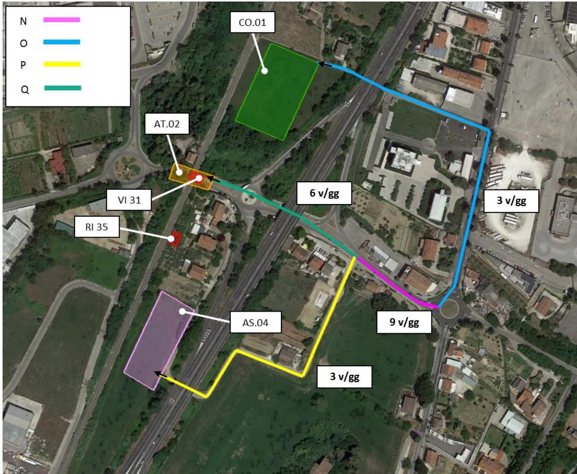
Figura 6-73 Viabilità di cantiere e flussi oggetto di modellazione in Aermid View (Scenario 3)
