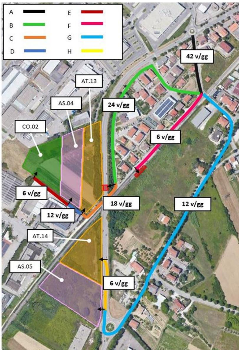
Figura 6-69 Viabilità di cantiere e flussi oggetto di modellazione in Aermid View (Scenario 1)
