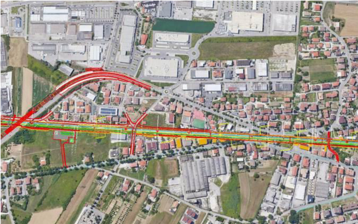
Fig. 11 – Raddoppio ferroviario dal km 4+550 al km 5+600
