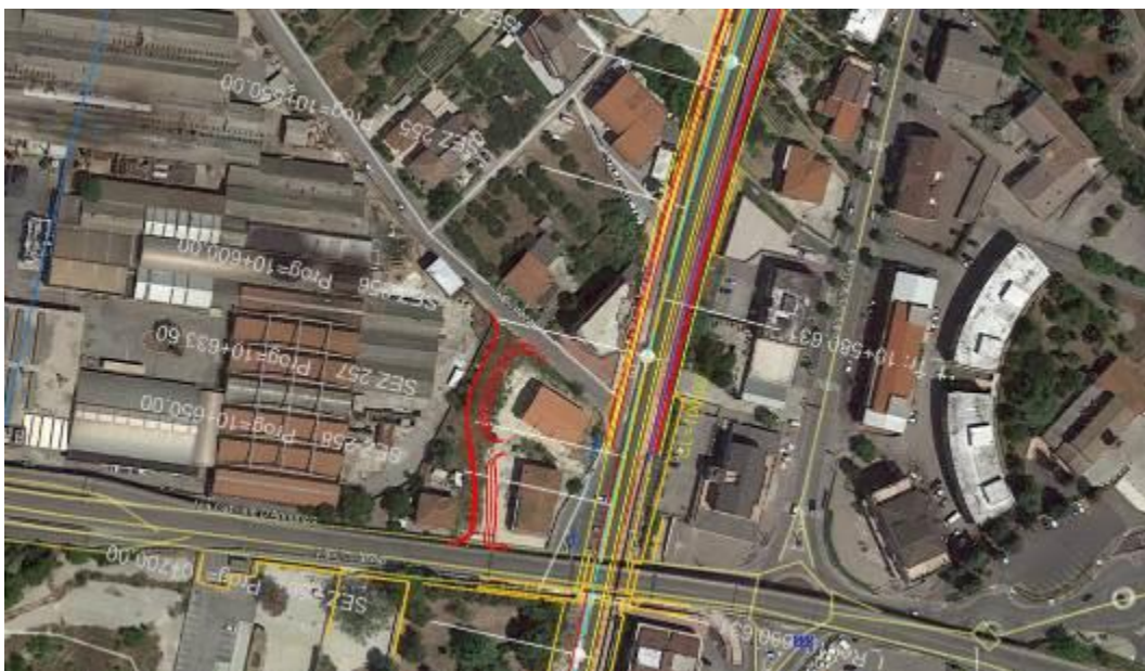
Fig. 68 - Ripristino della viabilità stradale di Via Custozza tra il km 10+615,971 ed il km 10+670,117 (NV17)
