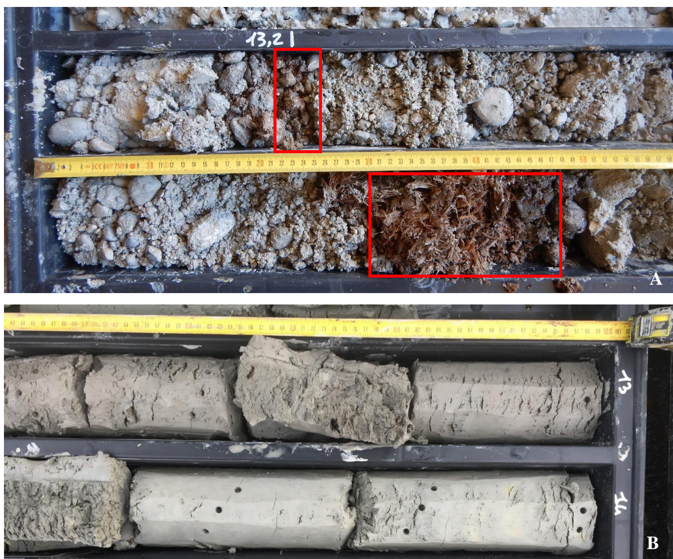
Figura 6-11. Foto di due particolari del sondaggio S8n (a) e sondaggio S3 (b), nella prima foto si possono individuare i ritrovamenti di radici e tronchi (casella in rosso), nella foto “b” dettagli di limi-argillosi grigi
