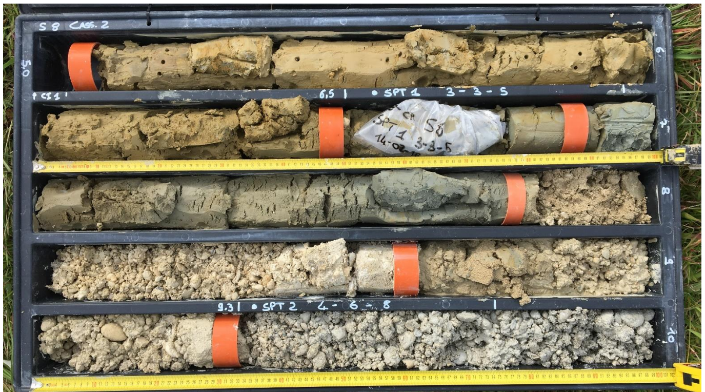
Figura 6-10. Foto rappresentativa della cassetta n2 del sondaggio S8, in cui si possono distinguere uno strato di limo-sabbioso di colore giallastro con intercalazione di un livello limoso-argilloso grigio, a profondità di 9.60 si nota il passaggio con ghiaie con matrice sabbiosa di colore avana
