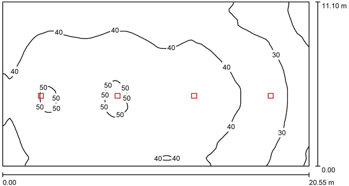
Altezza locale: 6.000 m, Altezza di montaggio: 6.000 m, Fattore di manutenzione: 0.80
