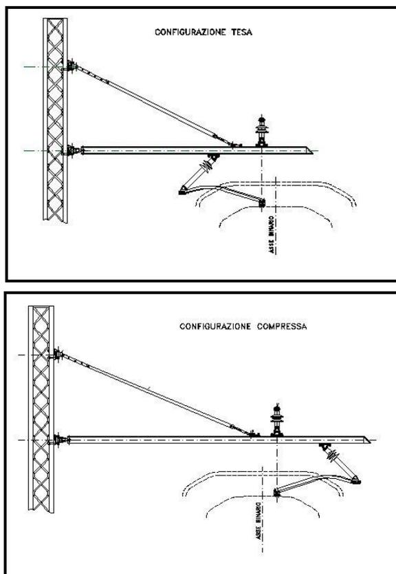
La sospensione è costituita da una mensola orizzontale in alluminio sostenuta da un tirante inclinato; entrambi sono collegati al sostegno per mezzo di attacchi a cerniera che permettono la libera rotazione della sospensione sul piano orizzontale al fine di consentirne il movimento longitudinale dei conduttori regolati automaticamente.
