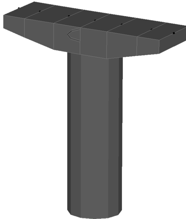
Figura 2.2: Modello agli elementi finiti della Pila
