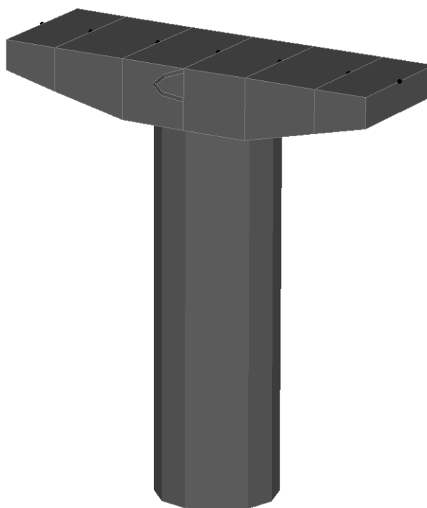
Figura 2.2 - Modello agli elementi finiti della Pila.
