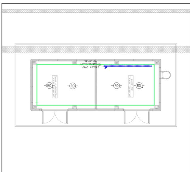
LOCALI PER IMPIANTI - PIANTA SOTTOPAVIMENTO
