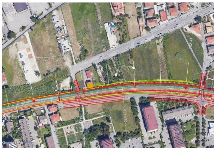
Fig. 15 - Viabilità ciclopedonale di Via Alessandro Volta al km 1+313,042 (NV02)
