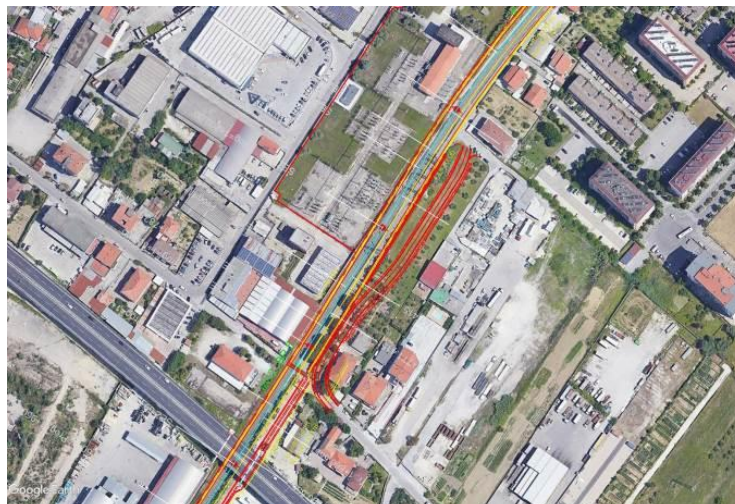
Fig. 16 - Ripristino viabilità stradale di Via Aldo Moro tra il km 1+618,529 ed il km 1+827,985 (NV03)
