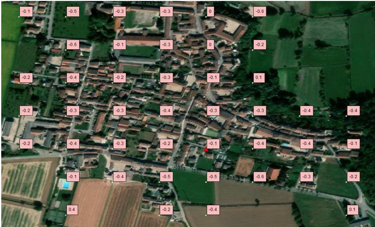
Fig. 19 Dati Regional scomposti secondo il vettore verticale vicino al punto di riferimento utilizzato per la scomposizione Local (triangolo rosso); in rosa i valori di velocità verticale calibrati. Il valore medio di velocità verticale per la calibrazione è stato calcolato all'interno di un cerchio di raggio di circa 200 m centrato sul punto di riferimento.
