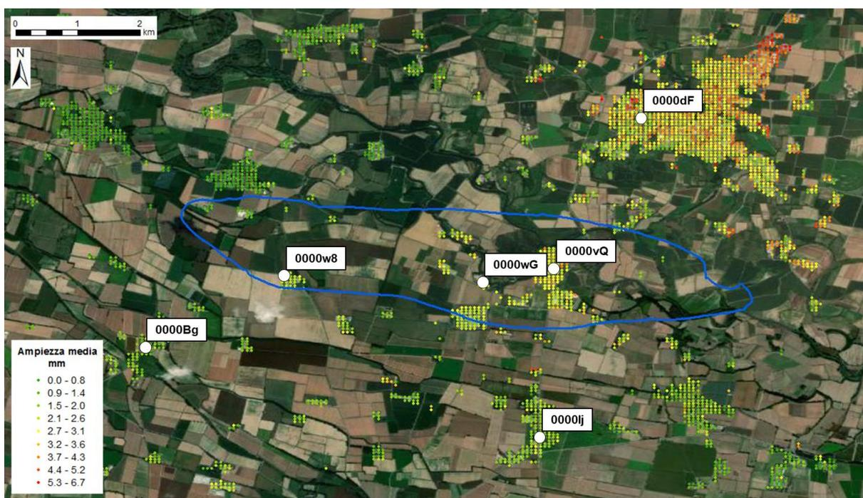
Fig. 37 Valori medi di ampiezza della stagionalità calcolati per la componente verticale dei PS Local e ubicazione dei 6 punti scelti rispetto alla proiezione in superficie del limite del giacimento.
