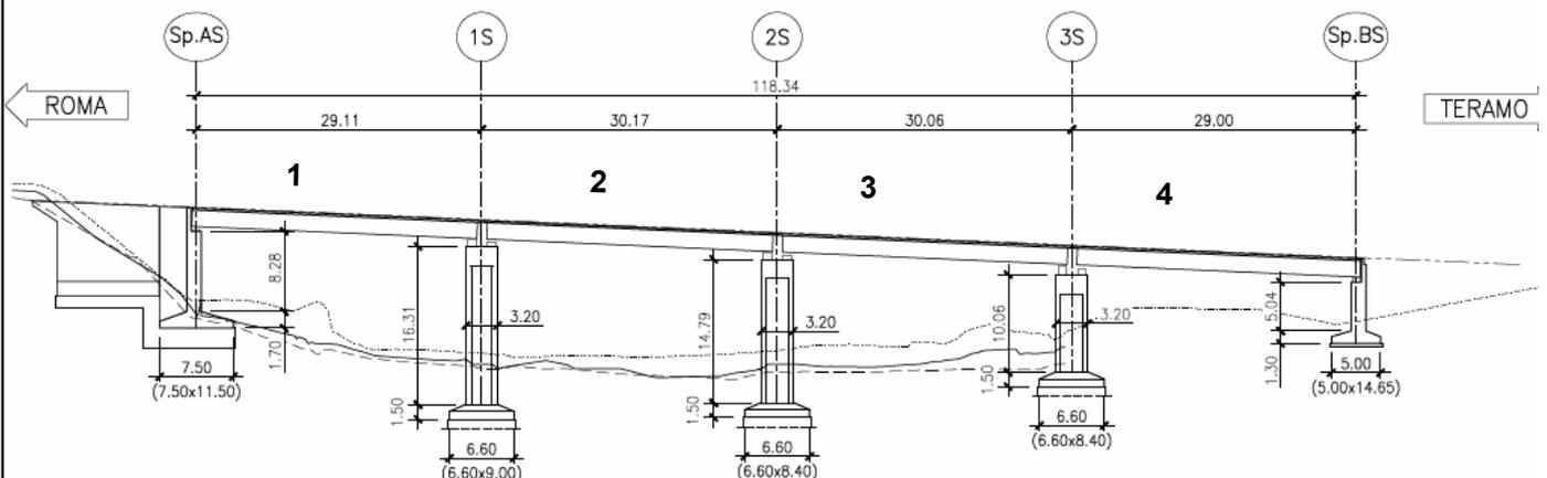
fascie di impalcato predisposte con demolizioni soletta e perforazione fori da mina nelle travi nelle quali realizzare le cerniere plastiche per l'abbattimento con esplosivi
