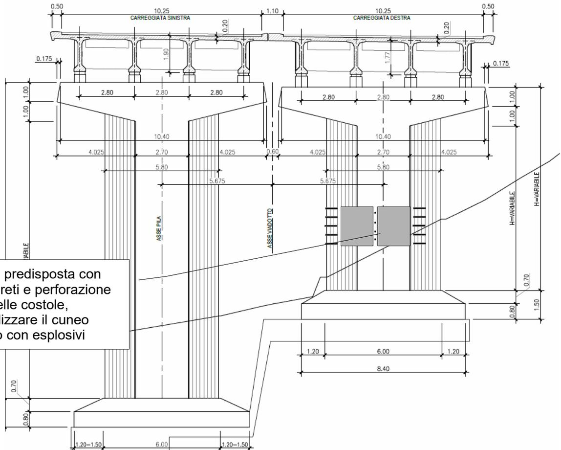
base della pila predisposta con demolizioni pareti e perforazione fori da mina nelle costole, nelle quali realizzare il cono di ribaltamento con esplosivi
