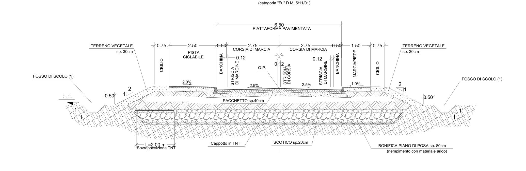
SEZIONE TIPO IN RILEVATO (rettifilo) - ASSE 5
