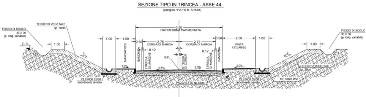
Figura 4 – Sezione tipologica in trincea dell'asse 44
