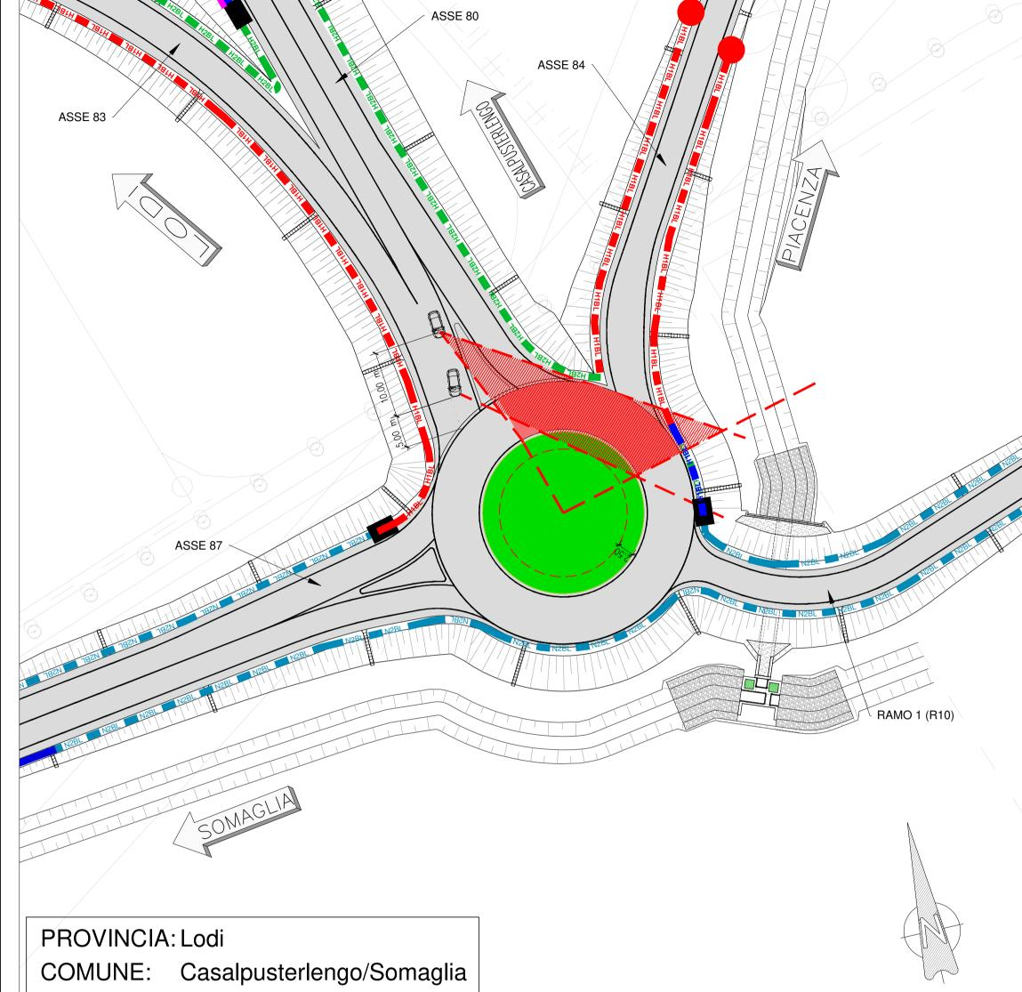
LEGENDA OSTACOLI ALLA VISUALE LIBERA BARRIERA METALLICA CLASSE "N2BL" Terminale semplice d'uscita per N2BL BARRIERA METALLICA CLASSE "H2W5" BORDO LATERALE (Anas) Terminale semplice d'uscita per H2BL ZONA LIBERA DA OSTACOLI PER CRITERIO DI VISIBILITA' AREA DI VISIBILITA' QUARTO DI ROTATORIA A SINISTRA TRAIETTORIA DI DEFLESSIONE BARRIERA METALLICA CLASSE "H1BL" NOTE SUL CALCOLO DELLA VISIBILITA' \_\_ §4.6 D.M.19.04.06
