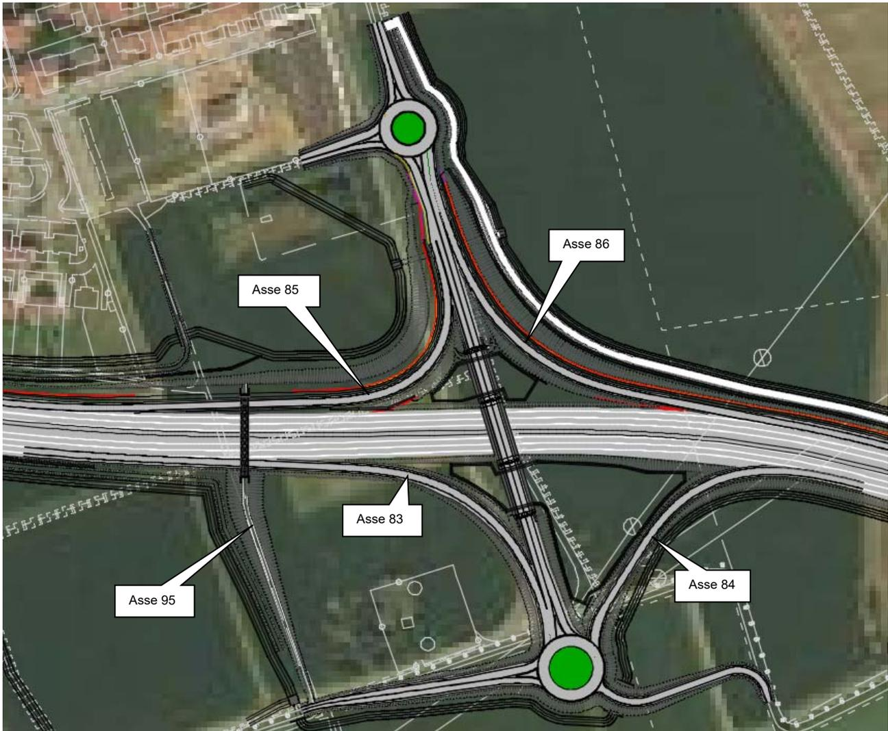
FIGURA 1 – WBS DL- CONFIGURAZIONE DI PROGETTO DEGLI ASSI STRADALI E DI UN ASSE CICLABILE
