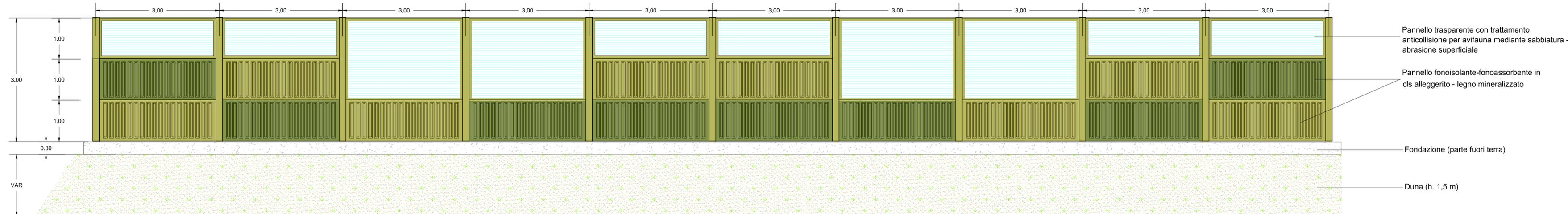
Pannello trasparente con trattamento anticollisione per avifauna mediante sabbiatura - abrasione superficiale
