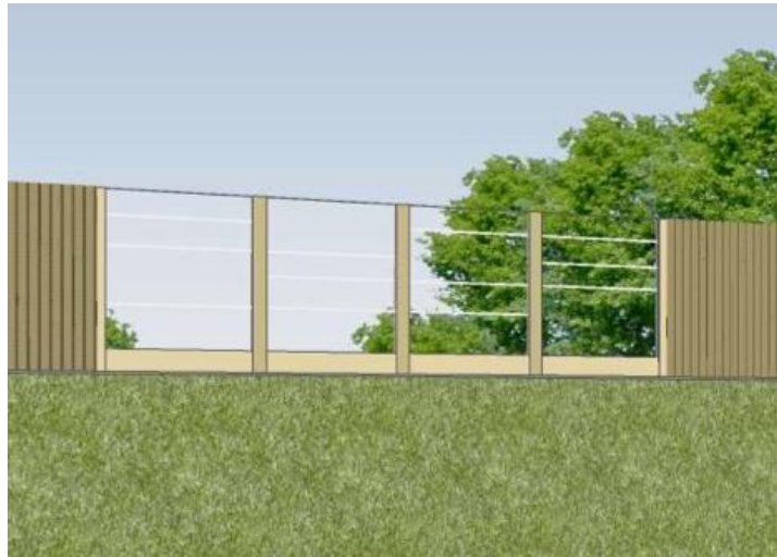
Tipologici per punti di raccordo duna barriera Tipo 1 – Finestre trasparenti in PMMA
