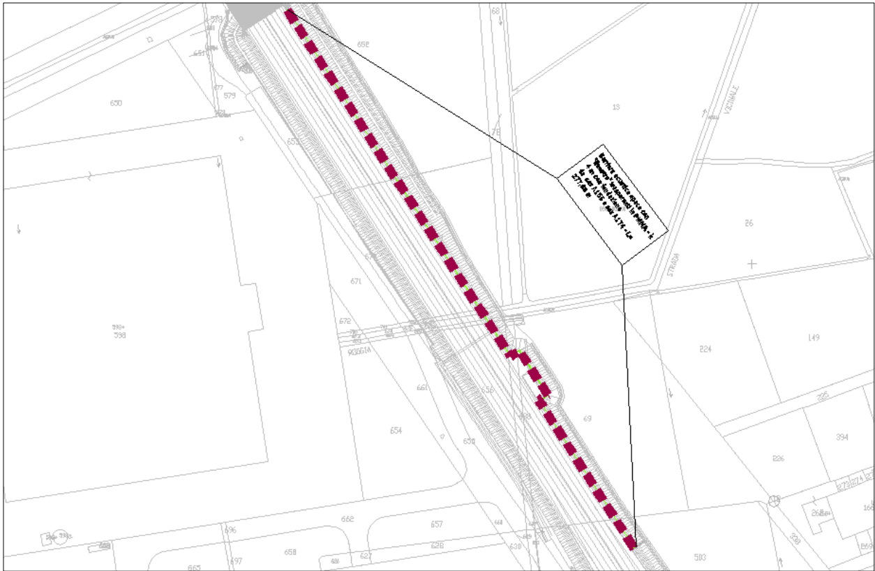
Figura 22 – Barriera h=4m posta all'altezza dell'intersezione con la linea ferroviaria Pavia-Codogno con termine all'altezza delle aree occupate dai capannoni industriali - Lato est
