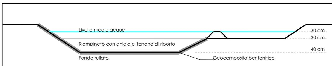
Sezione schematica del sistema di fitodepurazione
