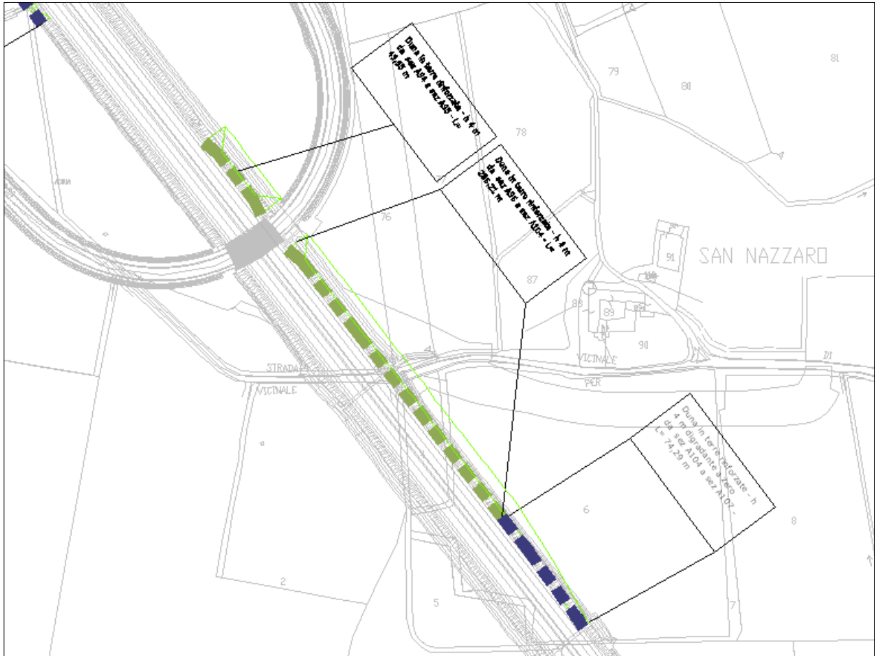
Figura 21 – Duna h=4m presso Cascina San Nazzaro - Lato est
