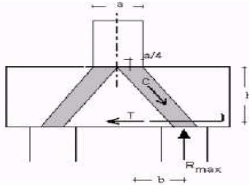
Per la verifica della fondazione è necessario per prima cosa stabilire la larghezza di zattera di fondazione competente al singolo palo, da assumere per il meccanismo resistente a tirante-puntone. si ottiene diffondendo il carico trasmesso dal palo secondo delle isostatiche a 45°, ed è pari a 3,03 m, come mostrato delle immagini successive:
