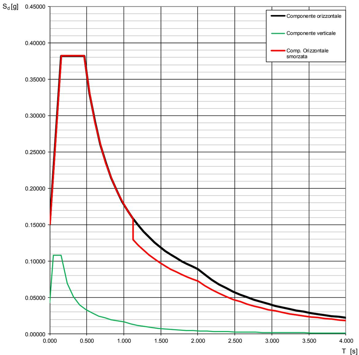
Spettri di risposta elastici (componenti orizz. e vert.) per lo stato limite: **SLC**
