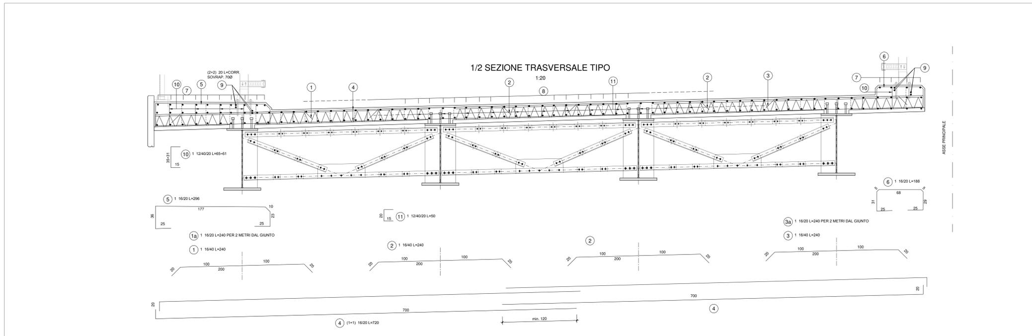
SEZIONE TRASVERSALE IN CORRISPONDENZA DELLA PILA (META SEZIONE)
