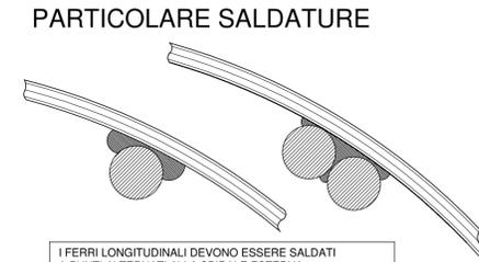
I FERRI LONGITUDINALI DEVONO ESSERE SALDATI A PUNTI ALTERNATI ALLA SPIRALE ESTERNA LE CERCHIATURE DI ESTREMITÀ SARANNO INVECE SALDATE A CIASCUNA BARRA LONGITUDINALE E LE SALDATURE ESEGUITE NEL MODO SPECIFICATO IN FIGURA
