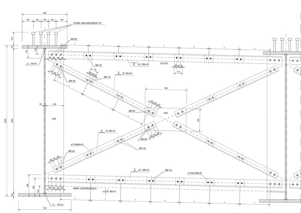
PARTICOLARE RITEGNO SISMICO LONGITUDINALE
