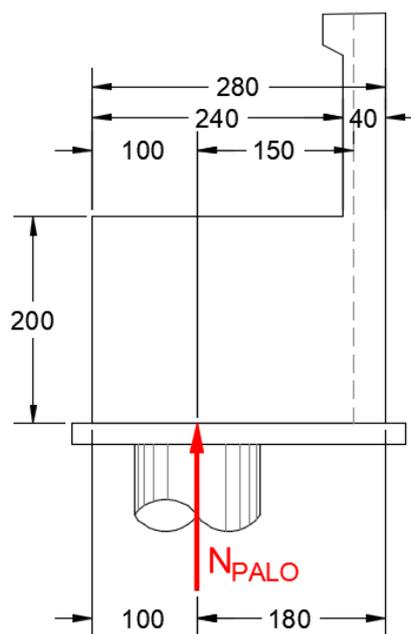
Di seguito si assume quindi un sistema a tirante-puntone isolato dal resto del plinto e di larghezza pari a **3,60 m**, nel quale il tirante è costituito da **18Ø20** (Area: **56,52 cm<sup>2</sup>**).
