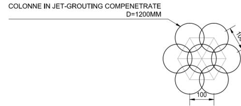
PARTICOLARE IMPERMEABILIZZAZIONE TRATTI MURO A "U"
