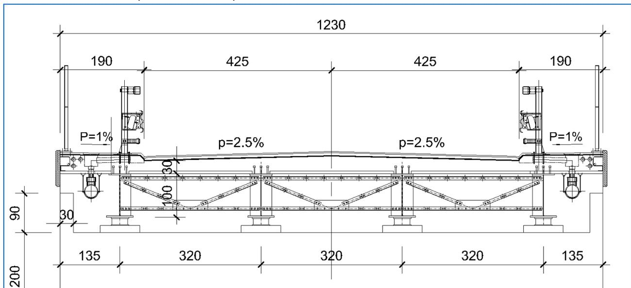
FIGURA 1 - SEZIONE TIPICA IMPALCATO (SU SPALLA)
