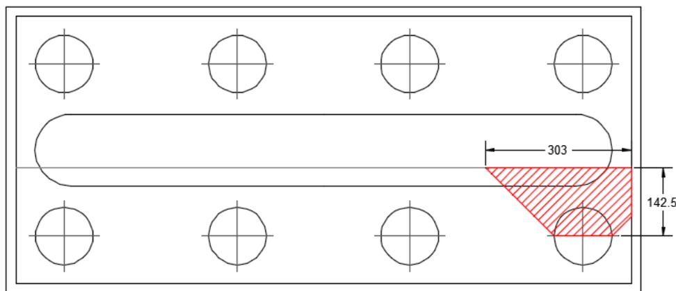
Di seguito si assume quindi un sistema a tirante-puntone isolato dal resto del plinto e di larghezza pari a **3,03 m**, nel quale il tirante è costituito da **15Ø26 + 15 Ø20** (Area: **126,75 cm<sup>2</sup>**).
