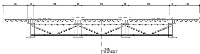
SEZIONE TRASVERSALE IN CORRISPONDENZA DELLE PILE
