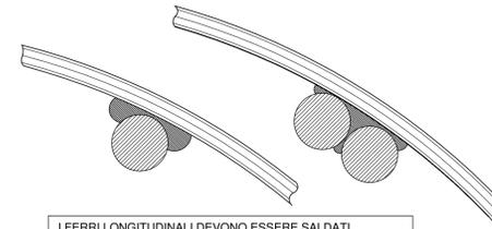
I FERRI LONGITUDINALI DEVONO ESSERE SALDATI A PUNTI ALTERNATI ALLA SPIRALE ESTERNA. LE CERCHIATURE DI ESTREMITA' SARANNO INVECE SALDATE A CIASCUNA BARRA LONGITUDINALE E LE SALDATURE ESEGUITE NEL MODO SPECIFICATO IN FIGURA.
