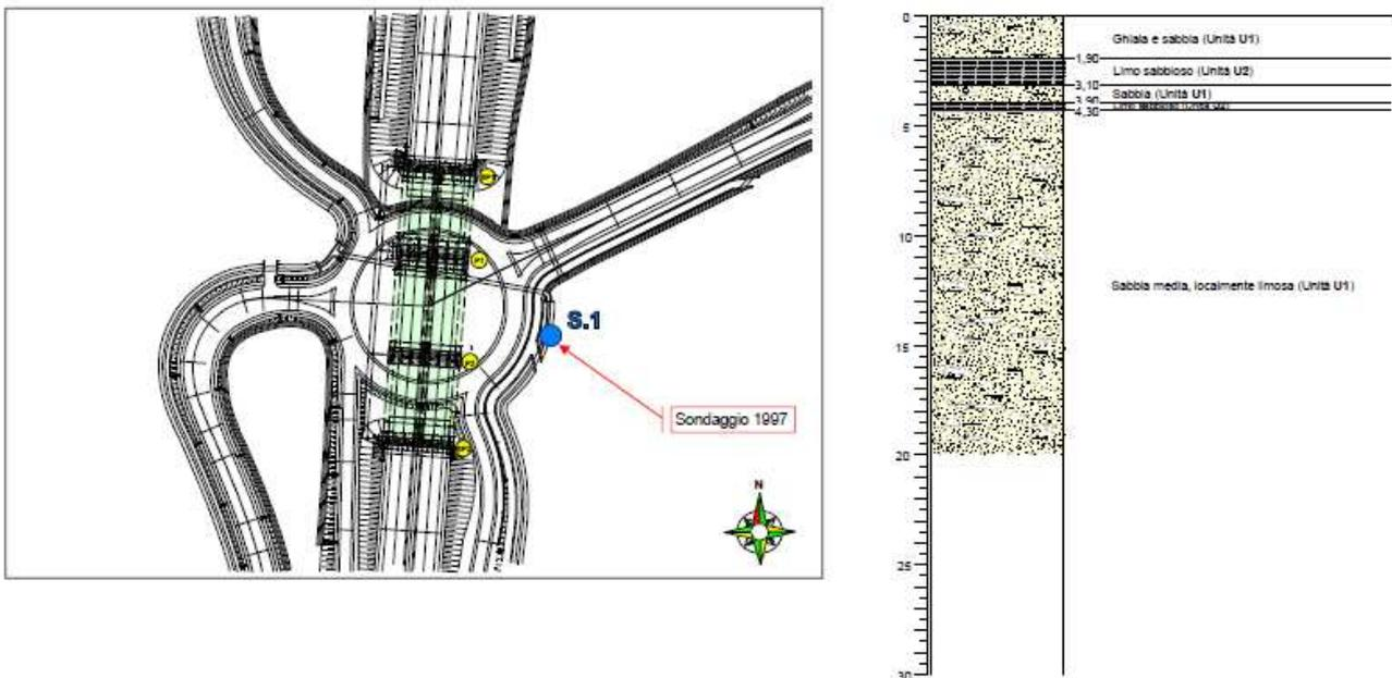
Ai fini delle verifiche geotecniche verrà considerato un numero di verticali indagate pari a 1. Dall'andamento stratigrafico del terreno si evince l'alternarsi di due unità litotecniche con le seguenti caratteristiche geomeccaniche:
