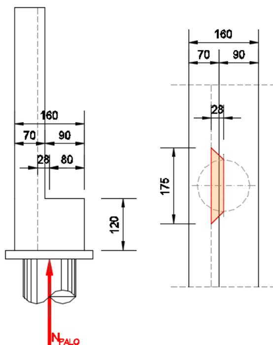
Di seguito si assume quindi un sistema a tirante-puntone isolato dal resto del plinto e di larghezza pari a **1,75 m**, nel quale il tirante è costituito da **17,5 Ø20** (Area: **54,95 cm<sup>2</sup>**).
