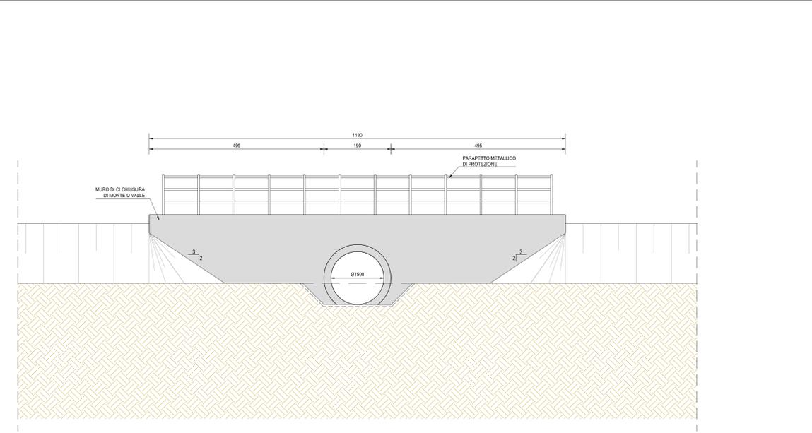
SEZIONE MANUFATTO DI INBOCCO/SBOCCO
