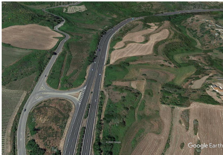
Figura 3 – Variabilità delle dimensioni dello spartitraffico
