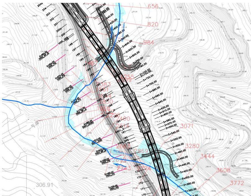
Figura 1.3 - Situazione Ante Operam, allagamenti a monte della viabilità esistente
