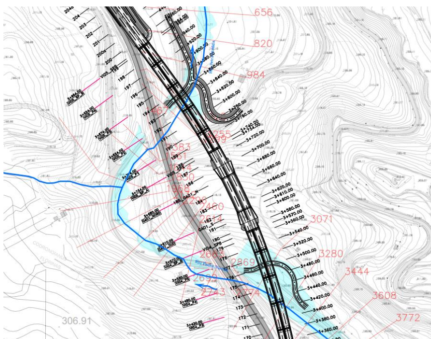
Figura 1.4 - Situazione Ante Operam, allagamenti a monte della viabilità esistente
