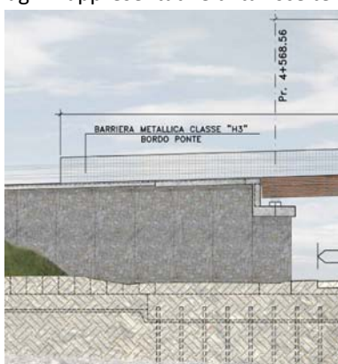
Muro di sostegno – Rivestimento con pannelli prefabbricati e rifinitura in pietra locale
