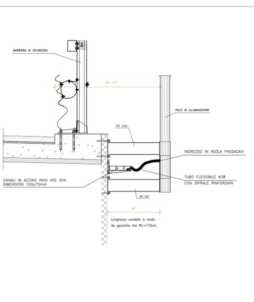
**VIADOTTI E PONTI - PARTICOLARE CORDOLO ZONA ANCORAGGIO PALI DI ILLUMINAZIONE - Scala 1:20**
