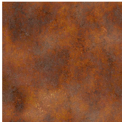
Acciaio COR-TEN – velette viadotto
