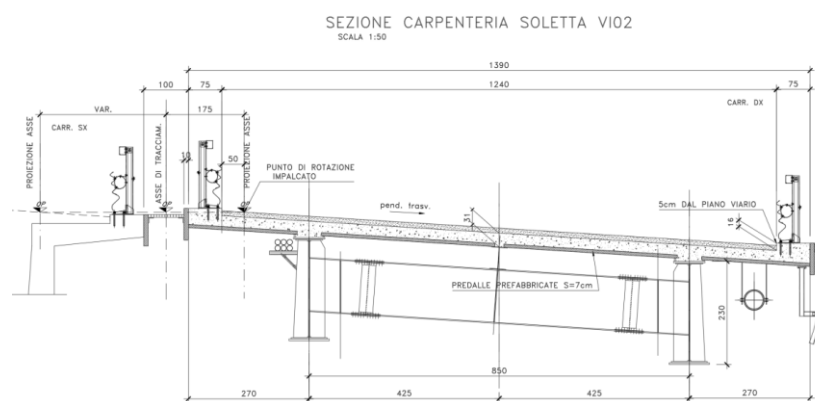
Figura 4-9 Sezione trasversale impalcato
