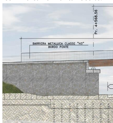
Muro di sostegno – Rivestimento con pannelli prefabbricati e rifinitura in pietra locale
