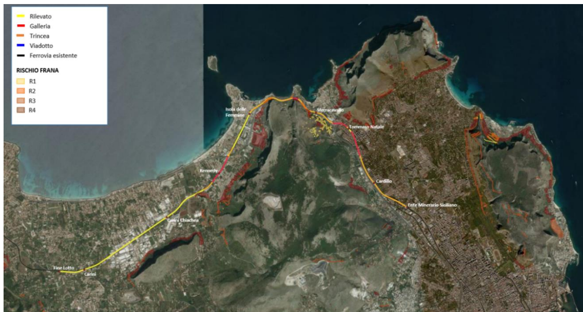
Figura 44. Sovrapposizione rischio frane (PAI) con l'ingombro stimato dell'intervento Nodo ferroviario di Palermo: tratta La Malfa/EMS-Carini
