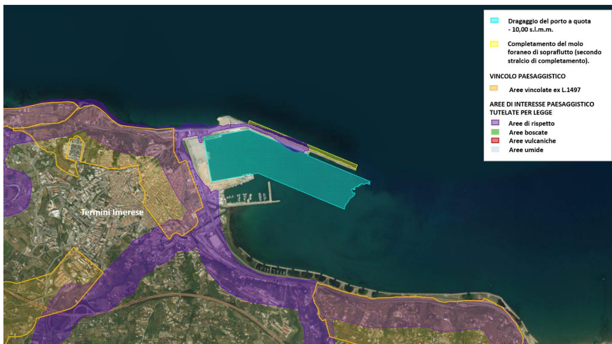
Figura 52. Sovrapposizione aree sottoposte a vincolo paesaggistico e aree di interesse paesaggistico tutelate con l'ingombro stimato degli interventi nel porto di Termini Imerese: Lavori di dragaggio del porto a quota - 10,00 s.l.m.m. e Lavori di completamento del molo foraneo sopraflutto (secondo stralcio di completamento).
