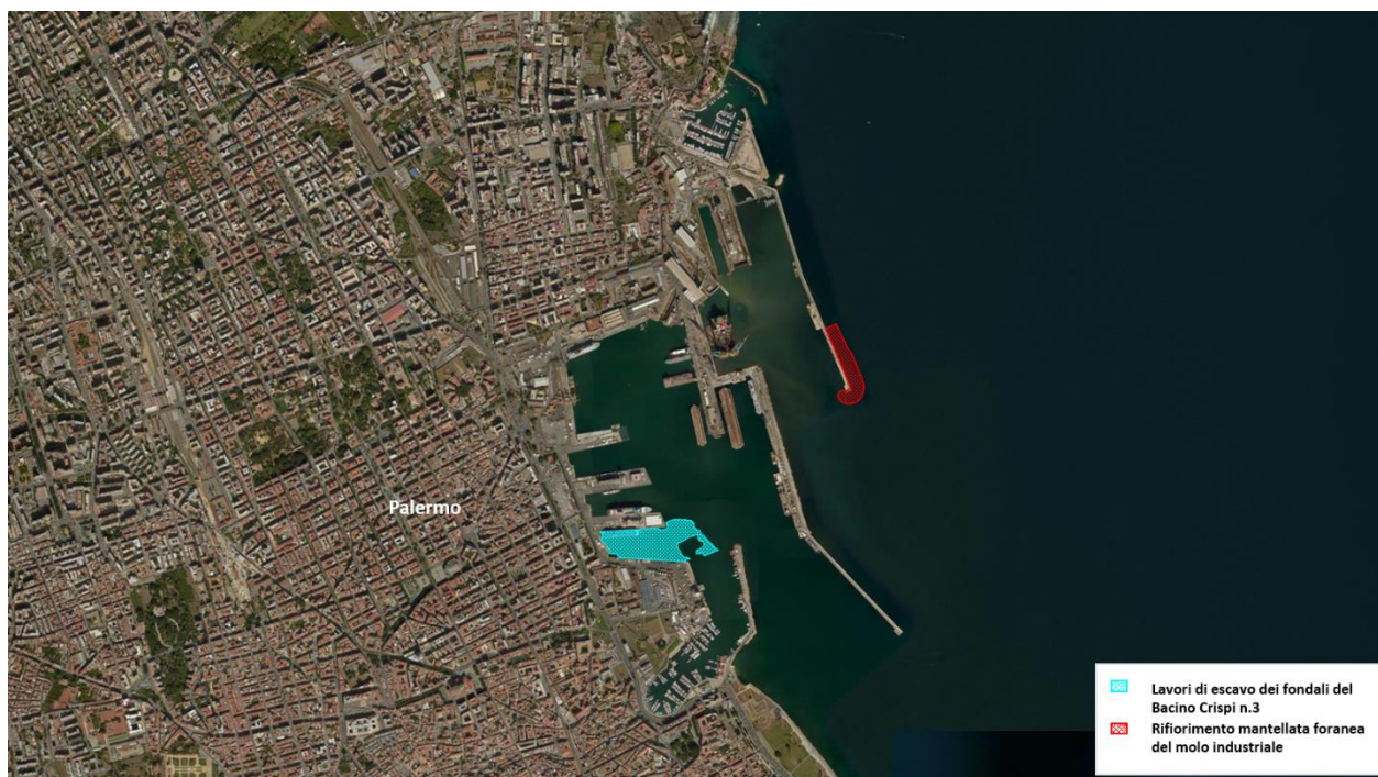
Figura 54. Porto di Palermo - Lavoro di escavo dei fondali del Bacino Crispi n. 3 e connesso rifiorimento della mantellata foranea del molo industriale
