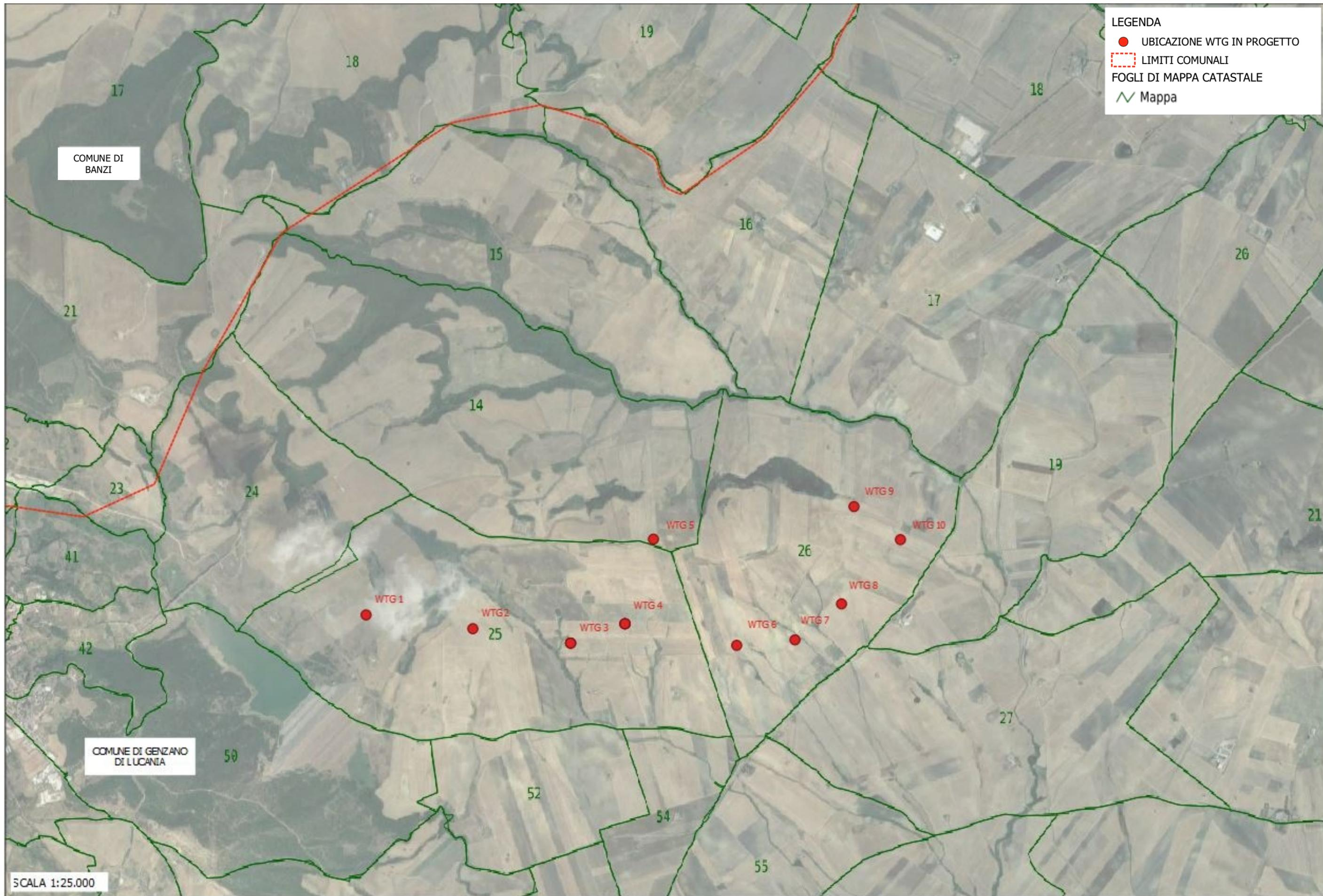
PROGETTO PER LA REALIZZAZIONE DI UN PARCO EOLICO COSTITUITO DA 10 TURBINE AVENTI UNA POTENZA COMPLESSIVA DI 45 MW E RELATIVE OPERE DI CONNESSIONE ALLA RTN DA REALIZZARSI NEL COMUNE DI GENZANO DI LUCANIA (PZ)
