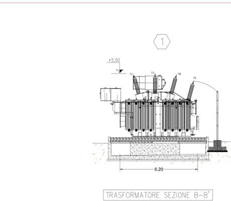
TRASFORMATORE SEZIONE B-B'
