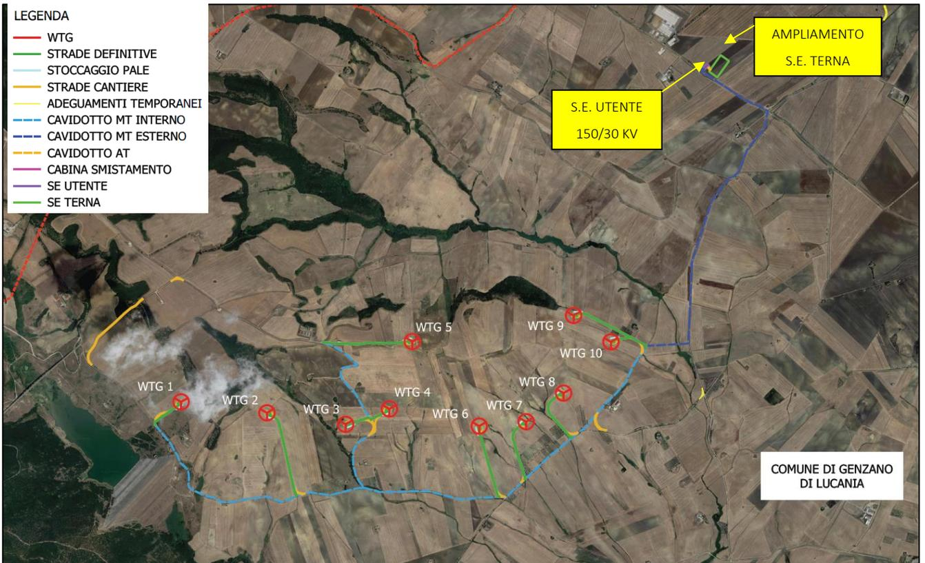
**Figura a-3: Area di intervento: dettaglio layout di progetto su ortofoto**
