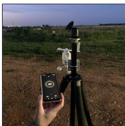
Fig. 10 – Punto di misura B c/o Ricettore PRC_2 – Misura parametri meteorologici e anemometrici
