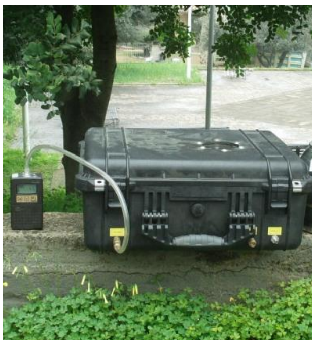
Figura 5.1.1.2-4 VAC-U-Chamber™ in cui è inserito il sacchetto di Nalophan, con pompa a vuoto in attività.
