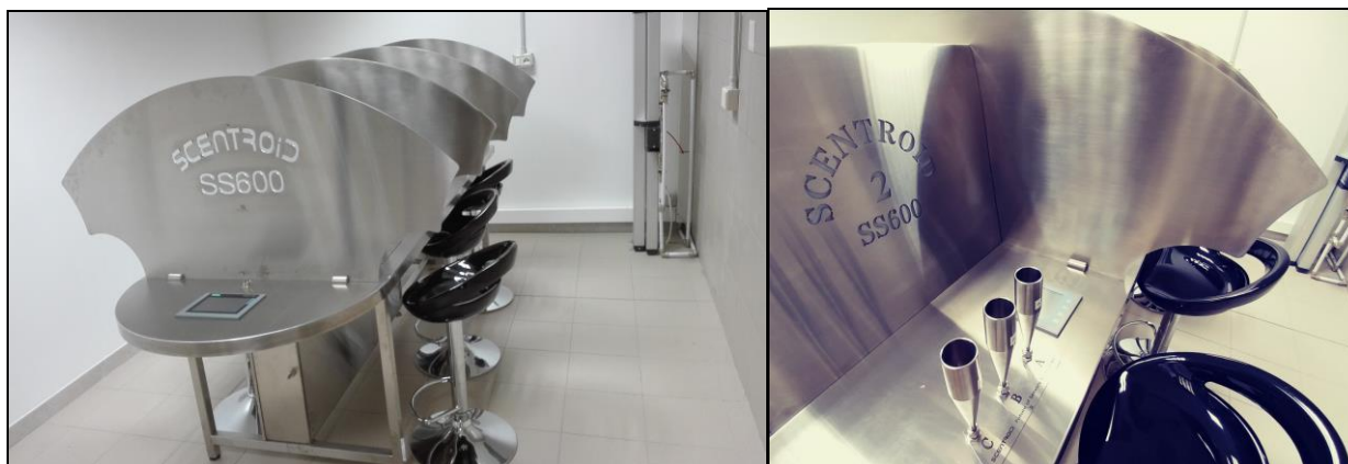
Figura 5.1.1.1-1 Tavolo Olfattometrico Sartec – SCENTROID SS600.
